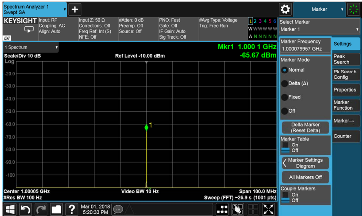
図5 Voltage Avg 検波モードでの観測波形
