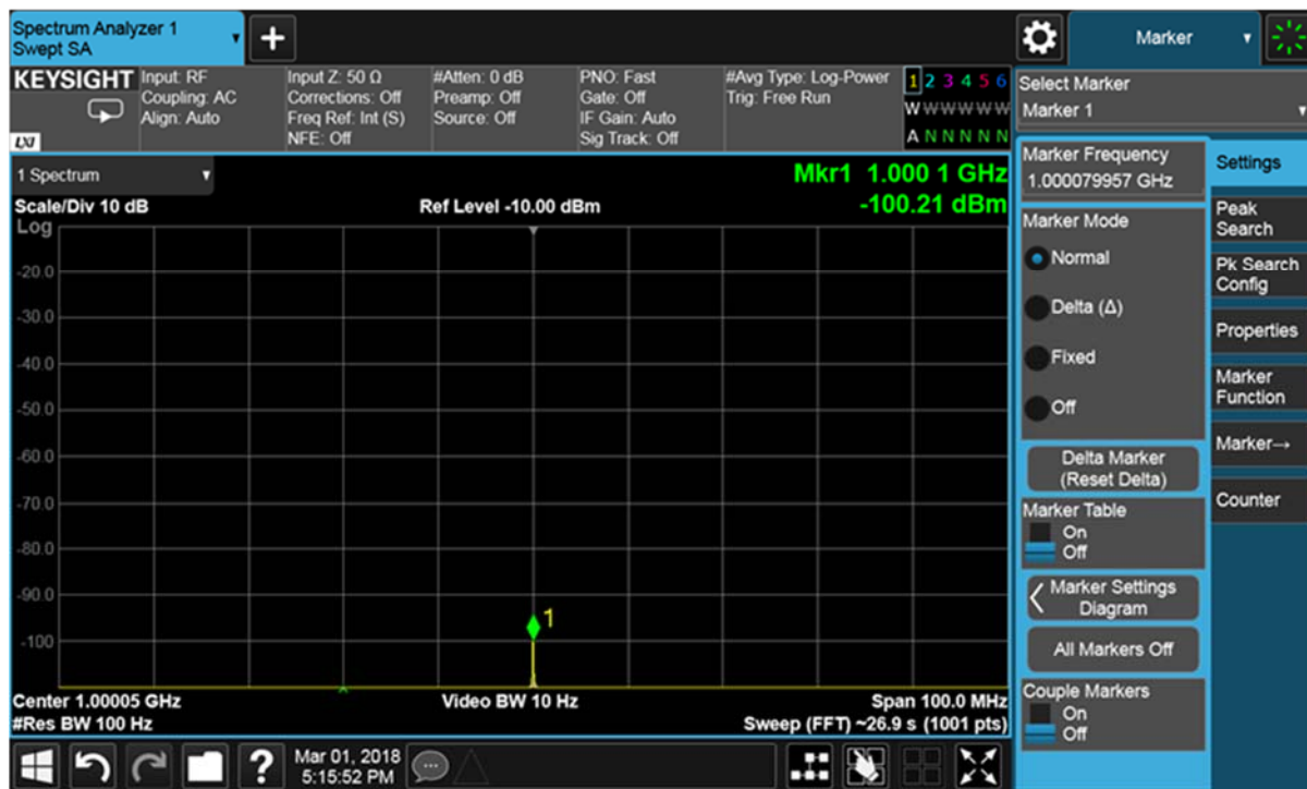
図 6 Log Power Avg 検波モードでの観測波形
